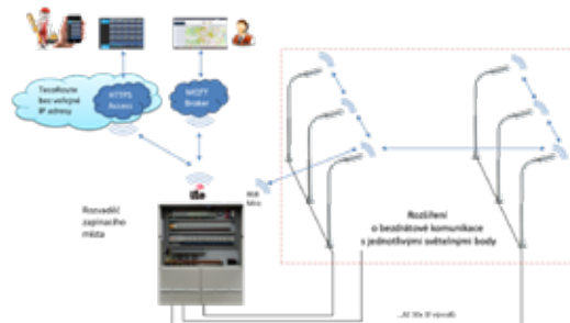
Obr. Koncept bezdrátové komunikace zapínacího místa veřejného osvětlení na nadřazený dispečink, komunikace se servisním personálem a komunikace s každým podřízeným světelným bodem. Komunikační a řídicí centrálou je tu nový Foxtrot 2 a přes jeho síť v pásmu 868 MHz lze připojovat i další senzory a přirozeně tak rozšiřovat internet věcí (IoT).
