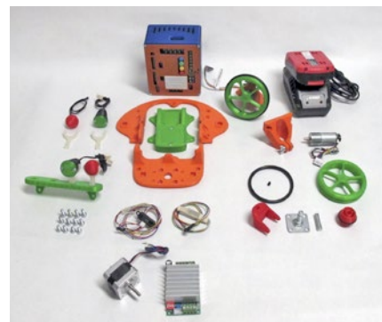
Stavebnice Foxee robot za podpory 3D tisku
