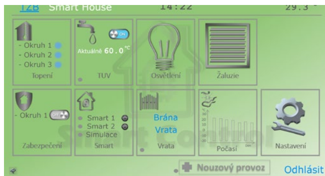
Obr. Úvodní obrazovka systému Smart Control umožňuje přejít ke všem technologiím v domě, sledovat jejich stav, zasáhnout ručně podle vlastního rozhodnutí ale také přednastavit logické, kvantitativní i časové podmínky pro plně automatické chování celého domu.
