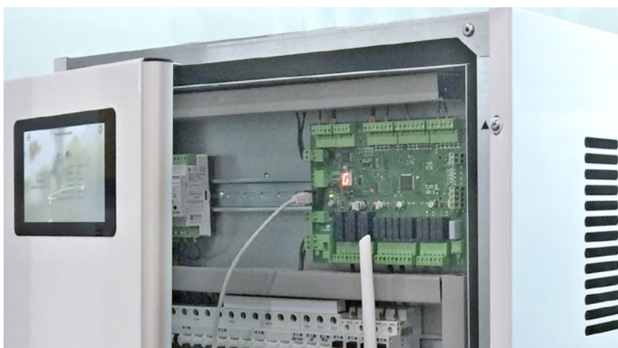
Obr. Na výstavě Aquatherm v Praze jsme nahlédli pod kryt Energyboxu. Za ovládacím displejem je tu umístěn vestavný Foxtrot v OEM provedení řady CP-1970.
