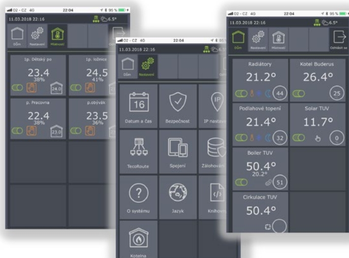
Obr. Aplikace v mobilním telefonu umožňuje jak přehledné, tak detailní zobrazení a ovládání každé místnosti. Lze v ní provádět i všechna další servisní a uživatelská nastavení. Funguje tak jako násobný wifi termostat s přístupem i přes internet
