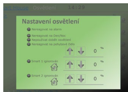
Obr. Podobně jako žaluzie také osvětlení je možno sledovat a ovládat z přehledové obrazovky a z ní také i přejít do nastavení individuálních řídicích podmínek pro každé světlo.
