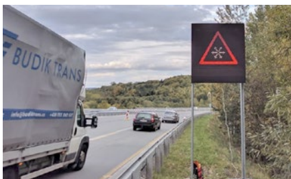
Obr. Foxtroty odvádějí svoji nepřetržitou práci také v informační tabuli o teplotě vzduchu 1 a povrchu dálnice na jejím šestém úseku a také na dvou výstražných proměnných dopravních značkách (PDZ) s informací o meteo situaci. Foto: Vít Jadrníček
