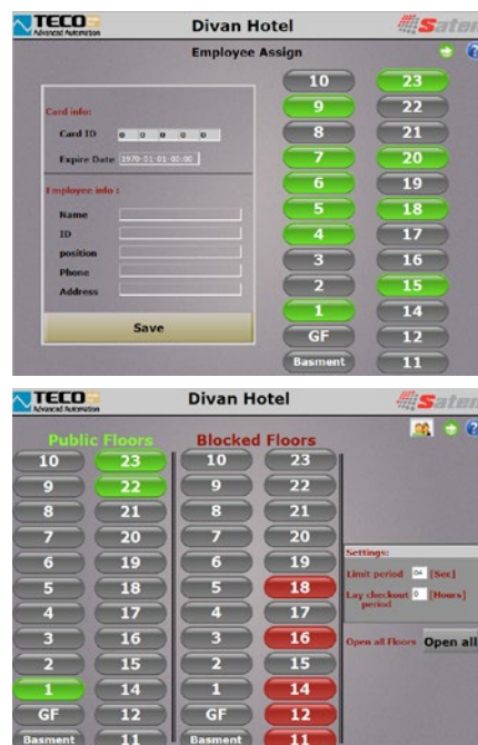
Obr. Ovládací stránky přístupového systému výtahů hotelu Divan. Byly vytvořeny v prostředí Mosaic a běží přímo na HW systému Foxtrot.
