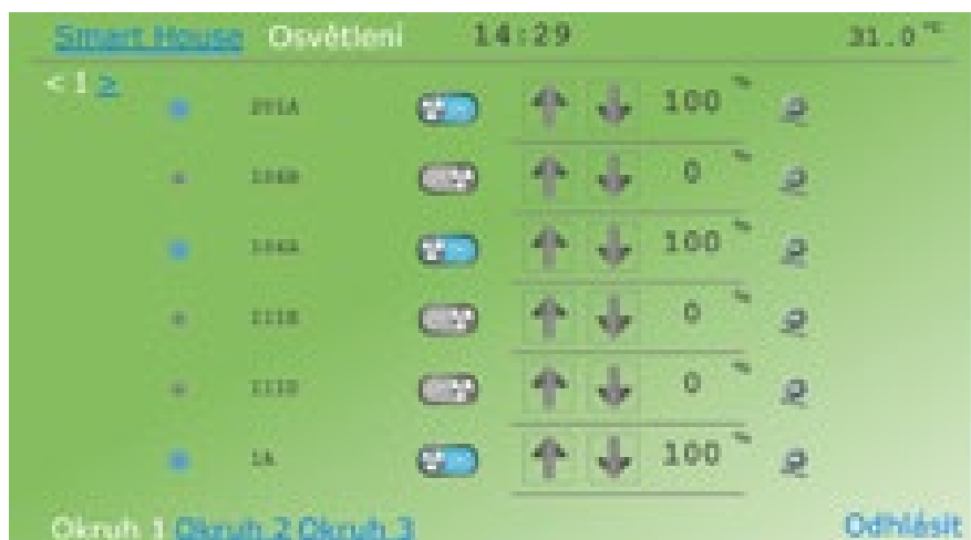
Obr. Úvodní obrazovka systému Smart Control umožňuje přejít ke všem technologiím v domě, sledovat jejich stav, zasáhnout ručně podle vlastního rozhodnutí ale také přednastavit logické, kvantitativní i časové podmínky pro plně automatické chování celého domu.
