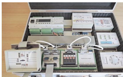
Obr. Kufr se základní sestavou EDUtec s Foxtrotem a pěti modely řízené soustavy řady EDU-mat, který lze u Ing. Kohouta objednat.
