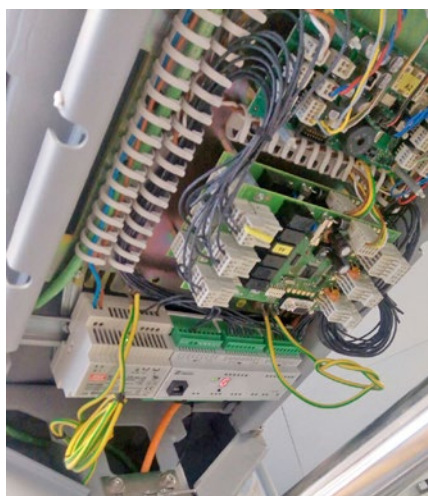
Obr. Centrální modul Foxtrotu vestavěný do turniketu
