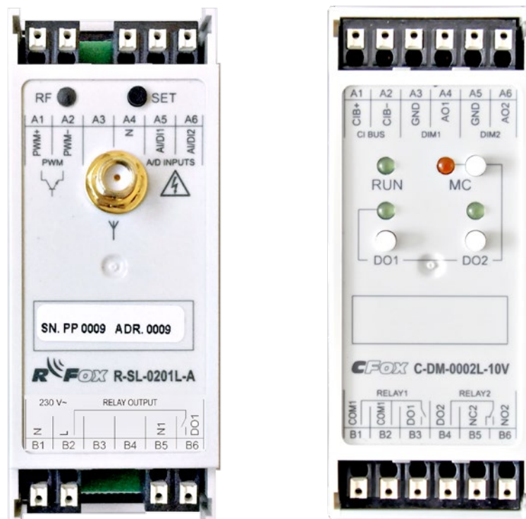
Obr. Moduly pro stmívání jednoho až dvou předřadníků pro použití v lampách veřejného osvětlení. C-DM-0002L-10V je dvoukanálový na sběrnici CIB, R-SL-0201L-A je jednokanálový připojovaný k centrále Foxtrotu bezdrátově na frekvenci 868MHz. Má k dispozici dva vstupy pro externí čidlo a vnitřní detektor velikosti primárního proudu pro diagnostiku funkce LED čipů na sekundární straně.
