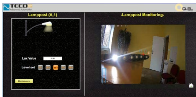
Obr. Přehledové obrazovky ovládání lamp veřejného osvětlení v referenční lokalitě města Nové Role. Poslední obrazovka je ukázka detailního nastavení konkrétní lampy. Zároveň je k dispozici streamovaný on-line pohled kamery instalované ve svítidle.
