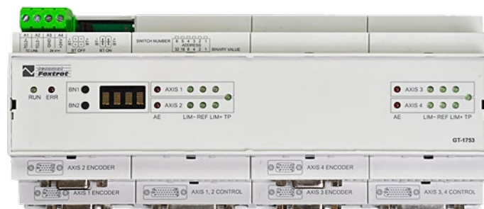
Modul GT-1753 pro řízení 4 os je v 12 modulové krabici na DIN lištu. Na šroubovací zelený konektor se připojuje napájení a systémová sběrnice TCLK2.
