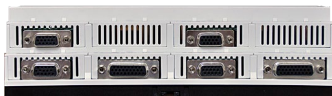
Ve spodní části se přes čtyři D-Sub15 konektory připojují snímače polohy. Na dvou D-Sub25 konektorech jsou po dvou výstupy ±10V DC pro ovládání servopohonu.
