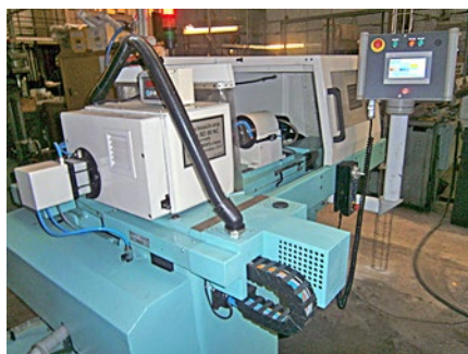
Jedno z prvních nasazení polohovacího modulu GT-1753 provedla pražská firma KASKO na automatické brusce BD 80 NC, která je určena pro broušení válcových a kuželových otvorů v sériové výrobě.
