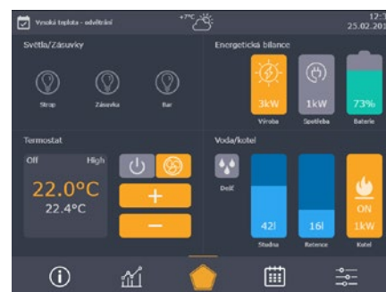
Obr. Ovládací obrazovka vyvinutá pro řízení a monitoring Českého soběstačného domu.
