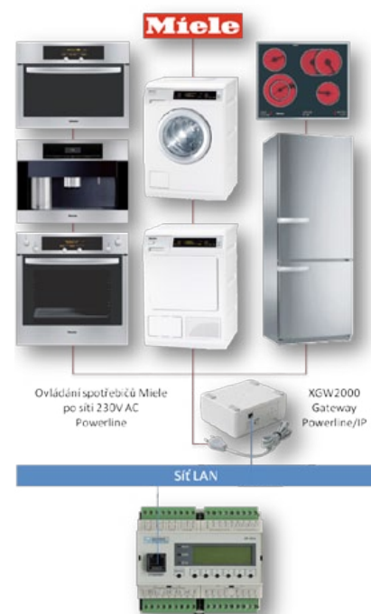
Schéma připojení spotřebičů Miele k Foxtrotu.
