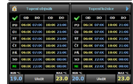
Dvojice obrazovek pro ovládní topení včetně uživatelského nastavení týdenního časového programu.
