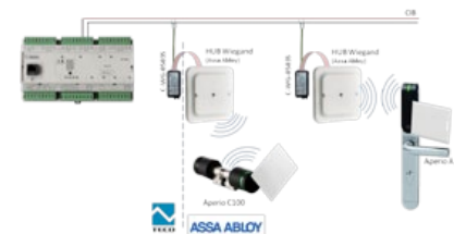
Schéma připojování více bezdrátových zámků na sběrnici CIB.
