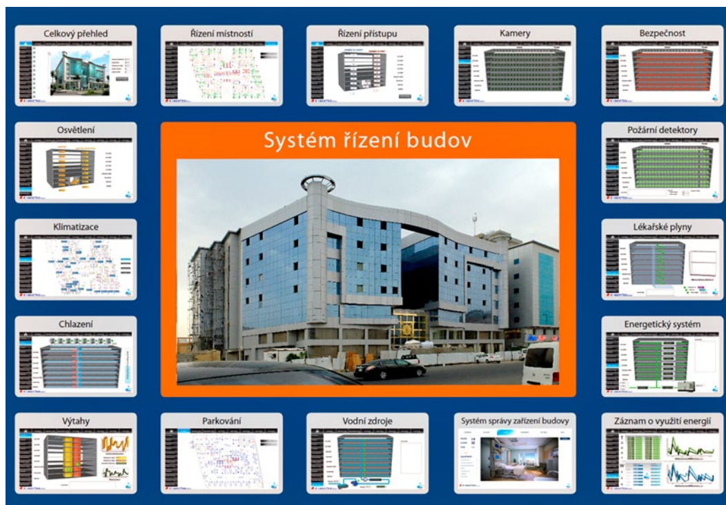
Obr. Reálná budova s komplexním řízením soustavou Foxtrox a dispečinkem se SCADA systémem Reliance4, ze kterého jsou i vizualizace jednotlivých provozních souborů. Jde o aktuálně dokončovanou nemocnici v Jedah v Saúdské Arábii. Realizace Kybertec s.r.o.
