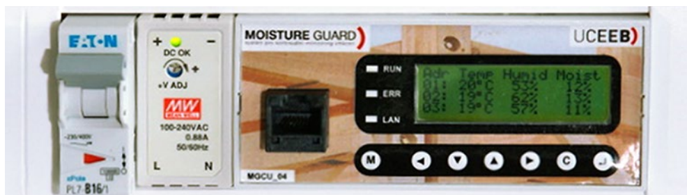
Obr. Centrální modul Foxtrot upravený na funkci měřiče vlhkosti z více specializovaných senzorů.
