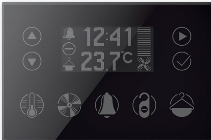
Obr. Rozložení kláves a OLED displeje na ovladači s integrovanými funkcemi pro hotel.
