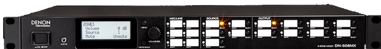
Obr. Ovládací prvky a displej na přední straně audio mixeru DENON DN-508MX, určeného k montáži do standardního 19" racku. Veškeré ovládání je dostupné i z grafického rozhraní Foxtrotu
