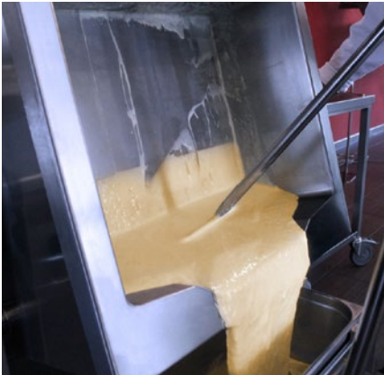
Obr. 2. Multifunkční zařízení je dodáváno i v tlakovém provedení, stačí jej napojit na přívod elektřiny, vody a na odpad; kuchař vkládá jen ingredience a vyjímá hotový pokrm; ostatní rutinní manipulaci a kontrolu teplot a energií ovládá Tecomat Foxtrot
