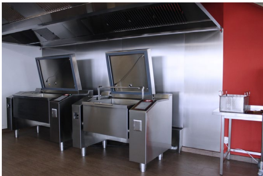
Obr. 1. Multifunkční zařízení pro gastroprovozy dodává firma JIPA International v několika velikostech; největší varianta MKH 201 má užitečný objem 200 litrů s rozměrem dna 1 429 × 580 mm a maximálním příkonem 58 kW
