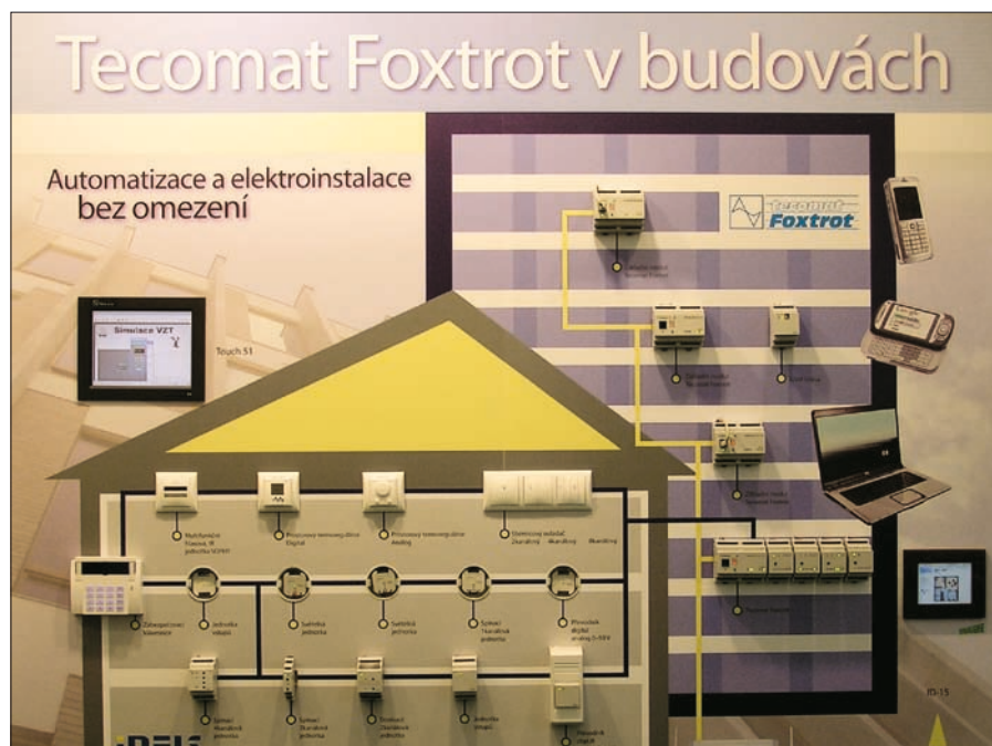
Obr. 3. Ukázkový panel použití systému Tecomat Foxtrot a INELS v budovách
