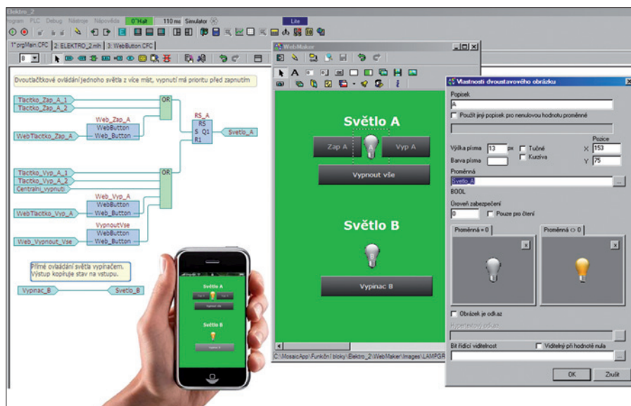
Obr. 3. Grafický program pro tlačítkové ovládání světla z více míst, tvorba jednoduché webové stránky s tlačítky a světlými, jejich navázání na program; výsledek lze průběžně kontrolovat např. na mobilním telefonu
