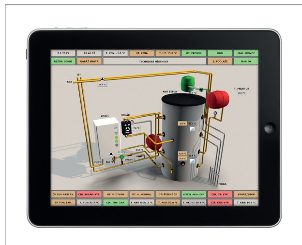
Obr. 4. Detail technické místnosti se stratifikační nádrží
