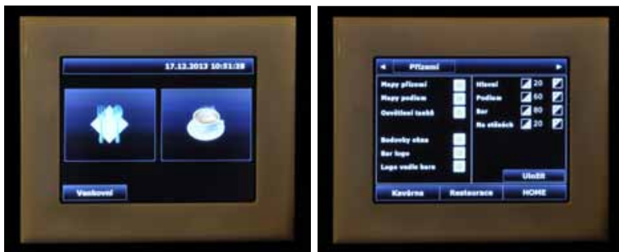
Obr. 2. Grafické ovládací stránky jsou součástí centrálního modulu Foxtrot; vlevo je základní rozdělení osvětlovacích prostorů: restaurace, kavárna a venkovní osvětlení, vpravo: ovládání nasvícení loga, tanků s pivem a dekoracních map na stěnách, a řízení stmívání hlavních prostorů pro hosty
