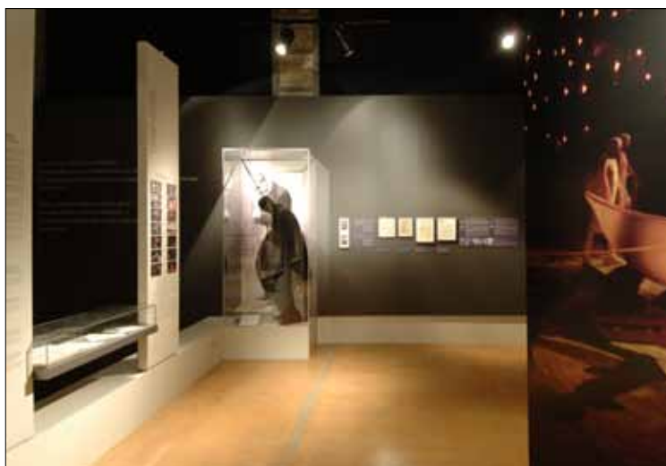
Obr. 6. Světlometry PAR 36 vytvářejí směřované osvětlení, intenzita je proměnná, řízená systémem Tecomat Foxtrot
